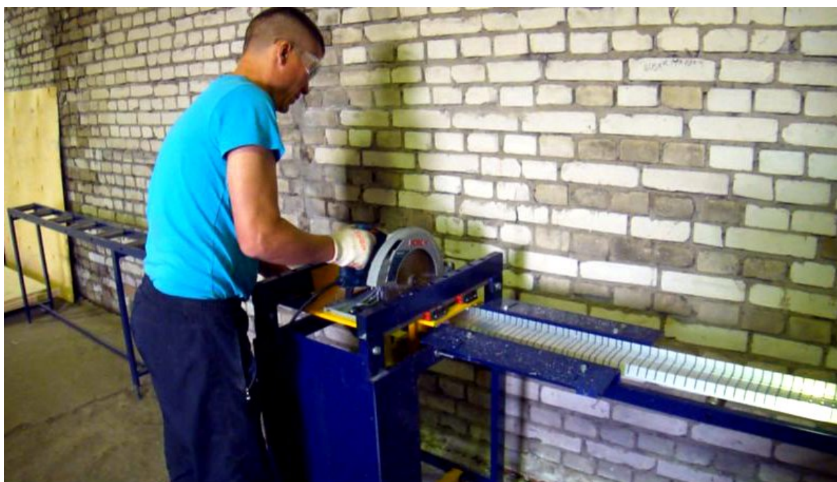
Рис. 3.2. Пила «Прозет» для выполнения надпиллов
